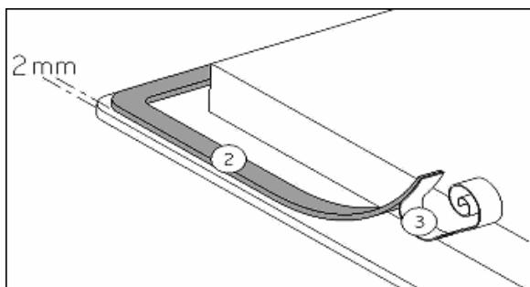
Die Dichtung (2) nach Abnehmen der Schutzfolie (3) mit 2 mm Abstand von der Außenkannte des Glases aufkleben.
