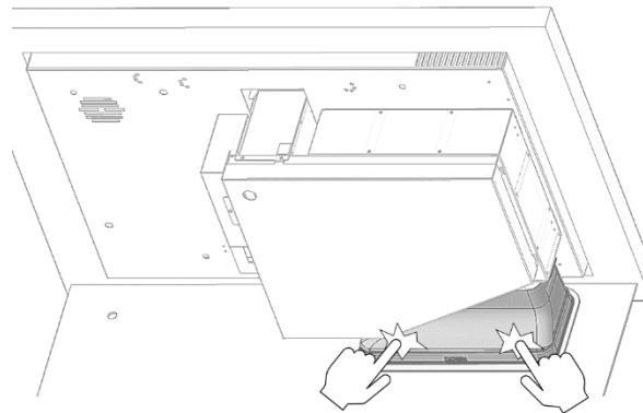
Une fois la table de cuisson et le conduit d'extraction en place dans le meuble, pressez le conduit contre le fond du meuble pour garantir l'étanchéité du montage.
