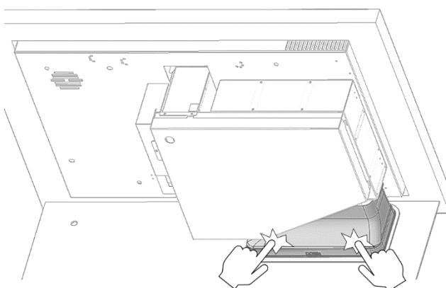
Sobald das Kochfeld und der Abluftkanal im Möbel positioniert sind, drücken Sie den Kanal gegen die Rückwand des Möbels, um die Dichtheit der Montage sicherzustellen.
