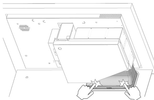
Eenmaal de kookplaat en het afzuigkanaal in de kast zijn geplaatst, drukt u het kanaal tegen de bodem van de kast om de afdichting van de installatie te verzekeren.
