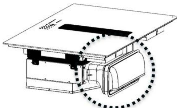
Pour la découpe du passage du conduit d'extraction à travers le meuble, se référer au gabarit fourni.
