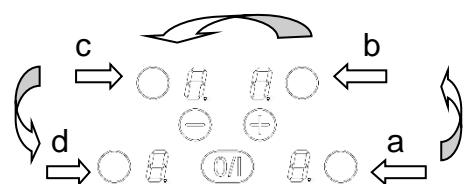
3) Lassen die Taste los. Dann drücken Sie gleichzeitig auf die [ - ] und [ + ] Taste, bis dass blinkende [ E ] Symbole angezeigt werden.
