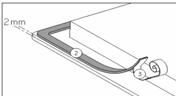
Nadat u de beschermfolie (3) hebt verwijderd, plakt u de afdichting (2) op een afstand van 2 mm van de buitenrand van het glas.
