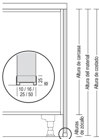
La altura del costado está acortada en la medida de altura interior del perfil y se calcula por ello de la forma siguiente:
